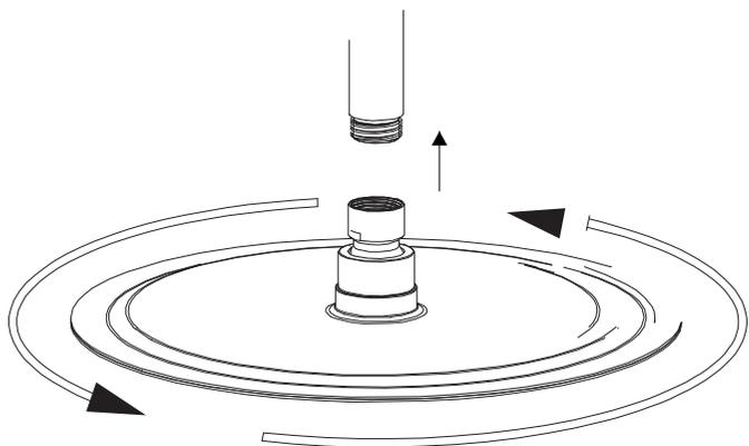
④ Drehen Sie die Regendusche nun auf das Anschlussgewinde des Brausearms (Wand- oder Deckenarm).
