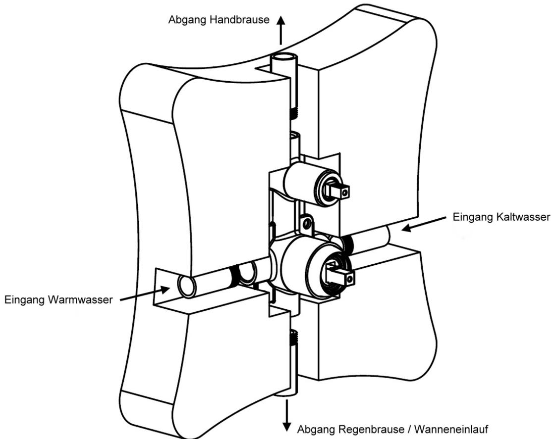
5. An den Abgängen der Armatur wird jeweils eine Wasserleitung zu dem Punkt gesetzt, an dem das gewünschte Produkt angeschlossen werden soll.
