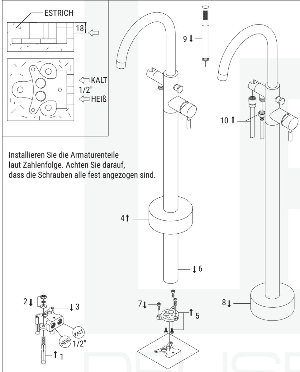
Installieren Sie die Armaturenteile laut Zahlenfolge. Achten Sie darauf, dass die Schrauben alle fest angezogen sind.
